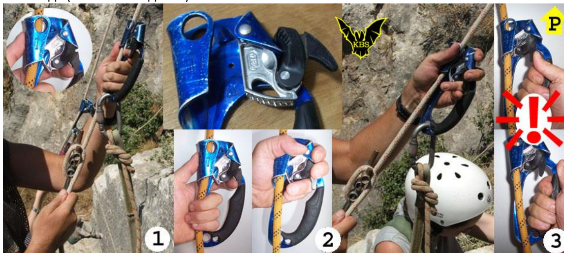
Рис.35. Самостраховочный эксцентриковый зажим "Petzl Ascension" с первым вариантом нескладного "Триггера Рефлекс" ("Reflex-ExS").
