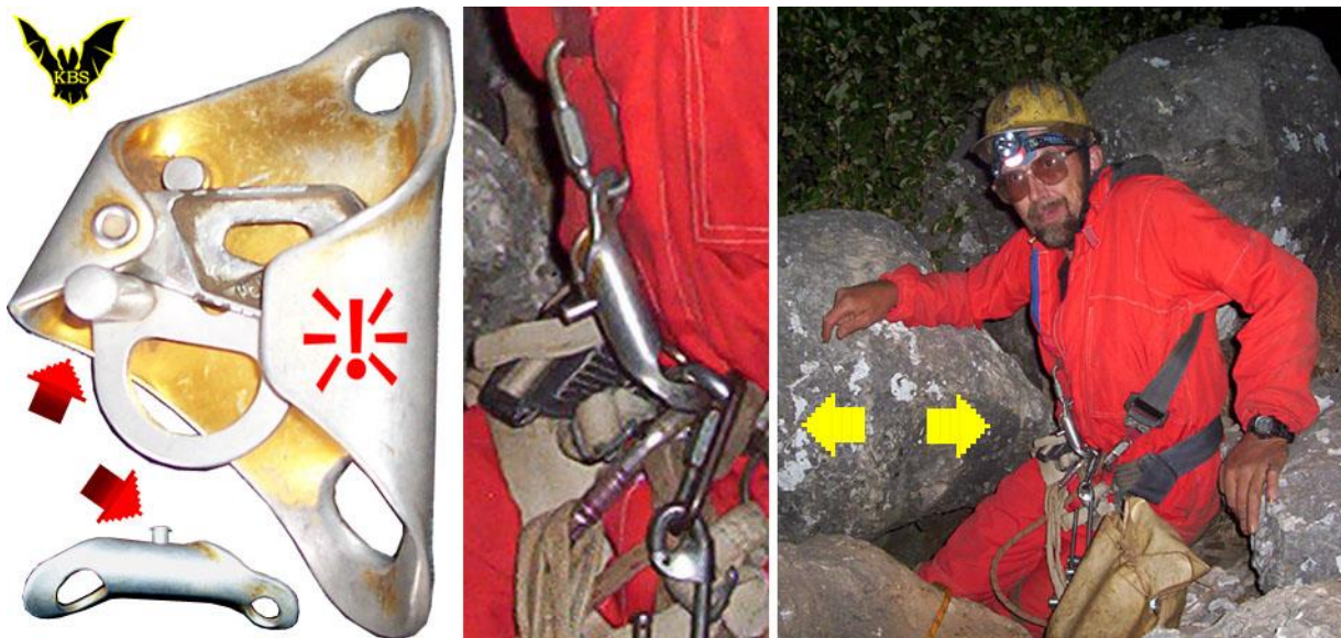
Рис.31. Опасность выступающего фиксатора кулачка зажима – автор на входе в пещеру Huta-26 (G-26), Израиль, где произошло выстегивание моего кролля из-за самодельного выступающего привода к фиксатору кулачка, 2004 год.
