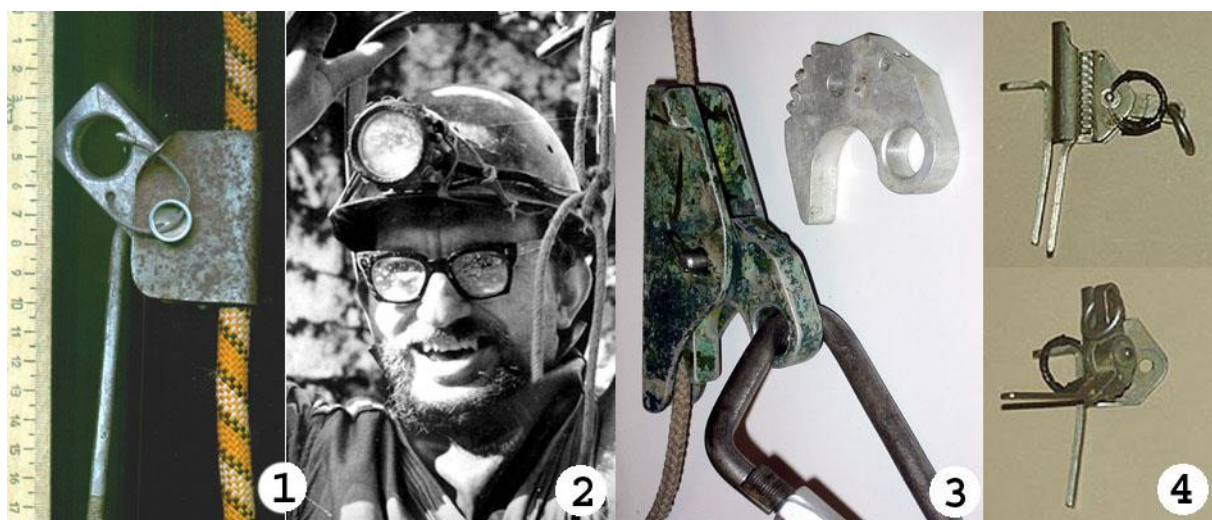
Рис.12. Советские самостраховочные зажимы, использующие хватательный рефлекс.
