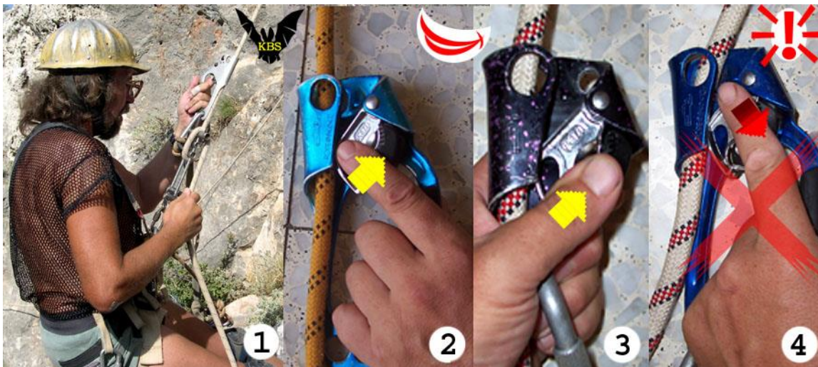
Рис.34. Эксцентрикые самостраховочные зажимы, управляемые при спуске отведением зашелки усилием, совпадающим с направлением хватательного рефлекса в случае срыва:
