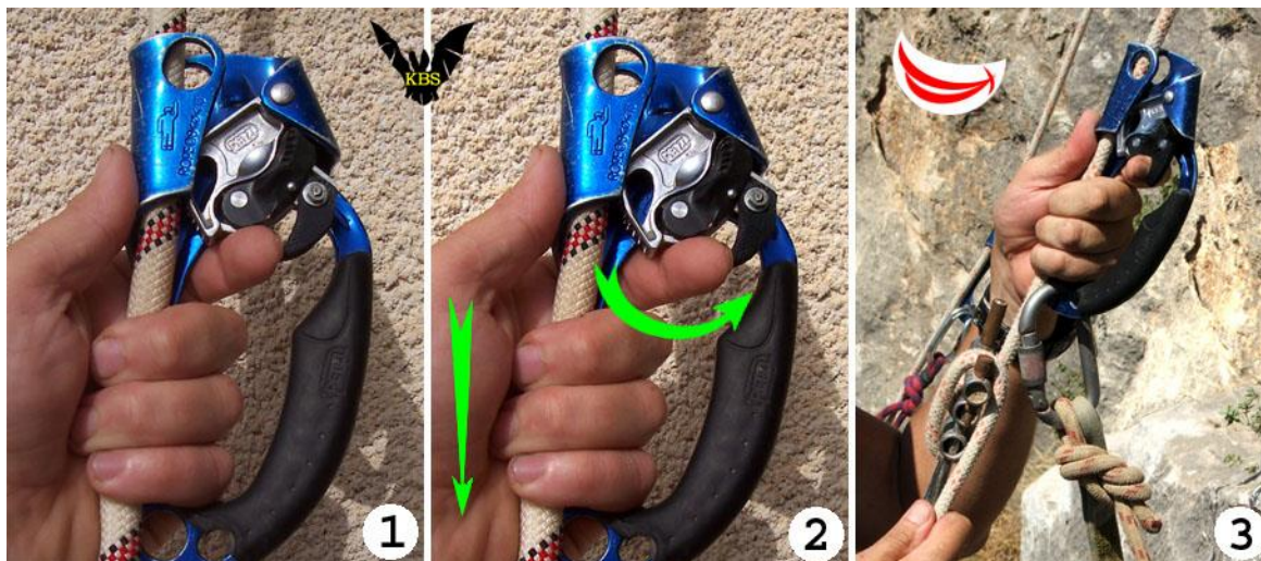
Рис.39. Ведение зажима с триггером "Рефлекс" при спуске:
