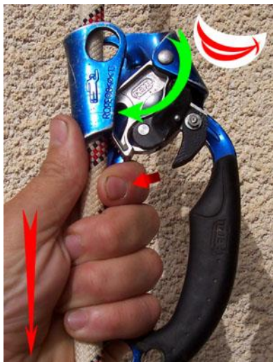
Рис.40. Срабатывание зажима, оснащенного триггером "Рефлекс" под действием хватательного рефлекса в момент утраты контроля над спуском.
