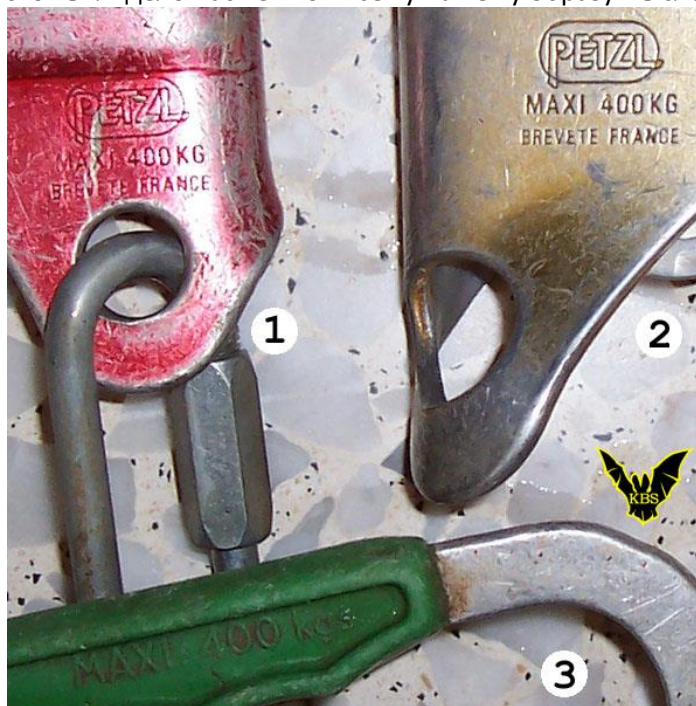
Рис.18. Мои зажимы фирмы "Petzl" от 1986 года с четко видимой маркировкой допустимых нагрузок – "Maxi 400 KG"
