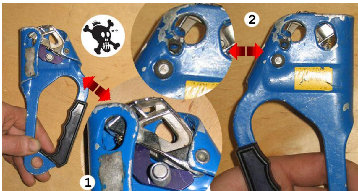
Рис.21. Непрочность ограничителей поворота кулачка в виде вклепанной бобышки зажимов производства Российской фирмы "АльТурС".
