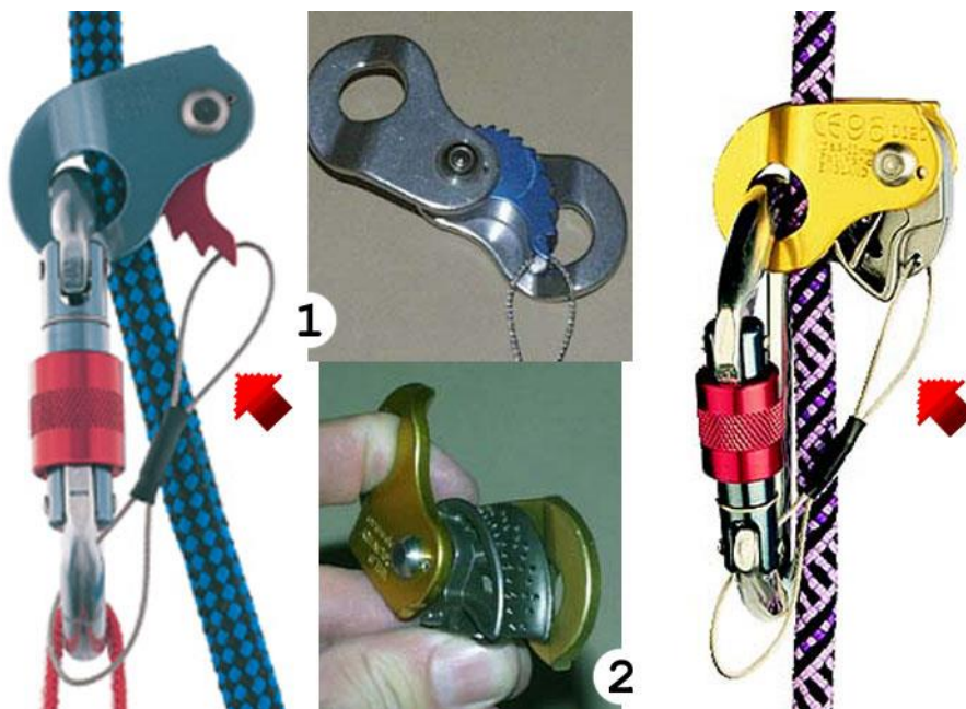
Рис.42. Зажимы фирмы "Wild Country Ropeman": 1 – "Ropeman" первой модели с зубчатым кулачком, которые подверглись испытаниям 2 – "Ropeman MK-II" с игольчатым кулачком.
