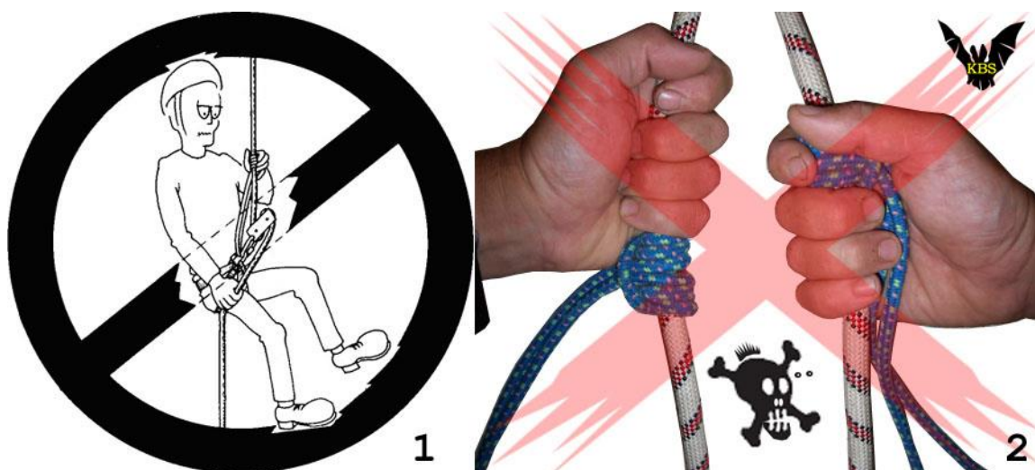
Рис.4. Захват узла и веревки над ним лишает его способности схватывать веревку:
