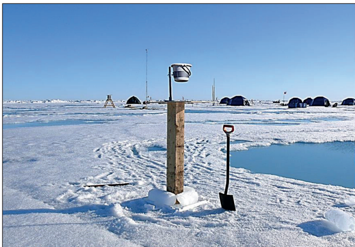
Рис. 2. Установка для сбора осадков на химический анализ, СП-35 [5]
