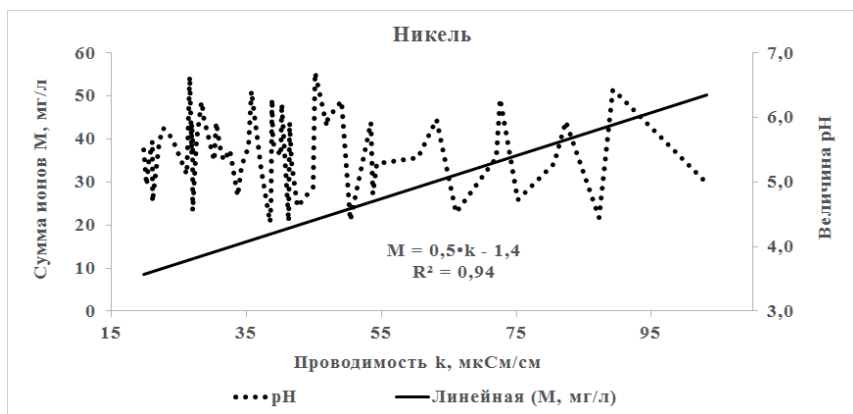
Рис. 33. Связь суммы ионов M и величины рН с проводимостью осадков k ионов на м/с Никель
