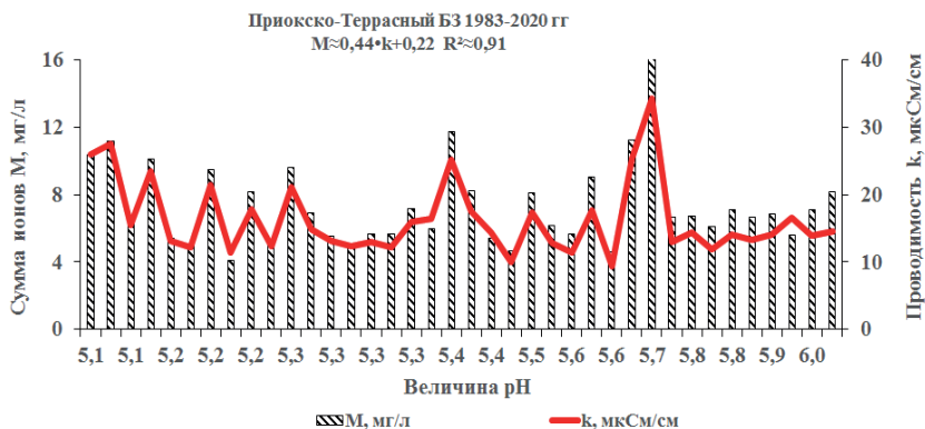
Рис. 204. Соотношение в атмосферных осадках между суммой ионов М, величиной рН и проводимостью k на м/с Приокско-Тerrasный БЗ
