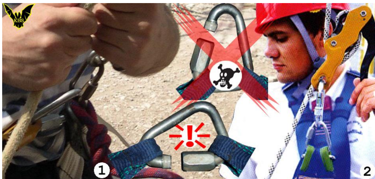
Рис.18. Положение беседочного МР "Дельта" влияет на безопасность подвески: 1 – Правильное положение муфтой вниз между несущими петлями беседки 2 – Смертельно опасное положение муфтой на открывание – с реальной возможностью "сняться" потом с дельты коннекторами ФСУ и другого снаряжения.
