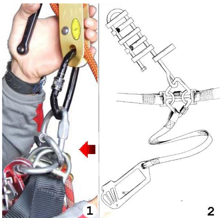
Рис.30. Дублирование разъемного присоединительного звена – замка беседки.
