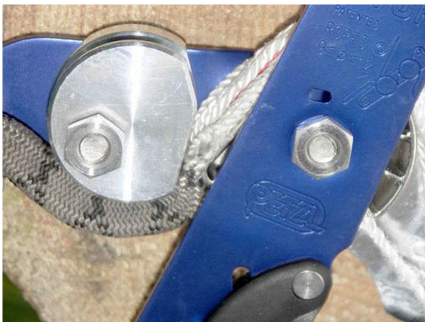
Рис.26. Аналогичные результаты получены Владом Еремеевым в Москве в 2006 году – "Petzl Stop" при падении груза 90 кг (у британцев груз был 100 кг) с фактором 1,0 снимает оплетку веревки, сплавля волокна в месте остановки.
