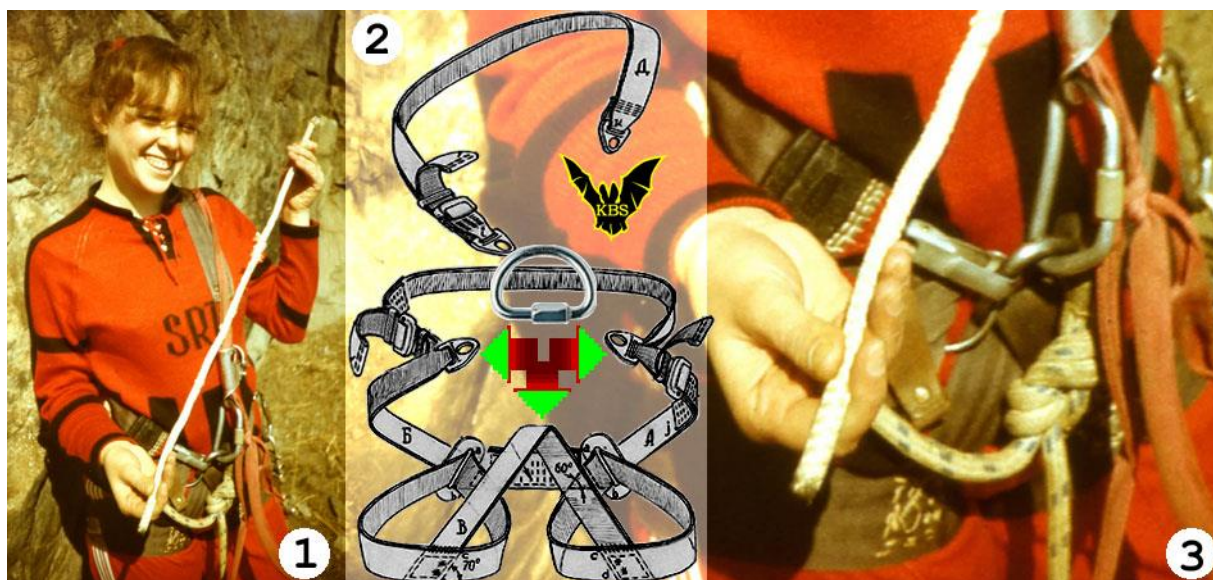
Рис.14. Три несущие петли – точки подвески, в беседке "Soumgan-SRT": 1 – Алина Гаузштейн в подвесной системе "Soumgan-SRT" на съемках учебного фильма по SRT, Усть-Каменогорск, 1987 год. 2 – Схема подвесной системы "Soumgan-SRT" с нерегулируемой петлей консольки. 3 – Внешний вид расположения "консольки" на дельте.
