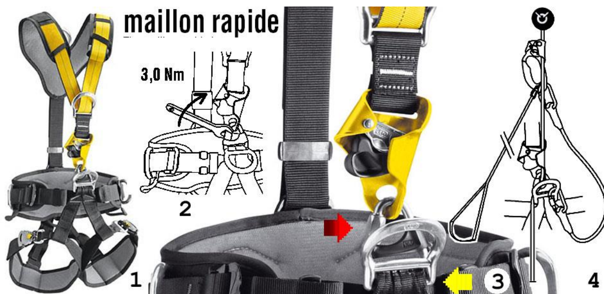
Рис.34. Подвесная система "Navaho Bod Croll Fast" фирмы "Petzl": 1 – общий вид системы с 3-мя отдельными присоединительными звеньями. 2 – указание инструкции закручивать дельту ключом. 3 – пластиковый фиксатор муфты дельты кролля и сдвоенные ремни, которыми вшито неразъемное присоединительное кольцо (по желтой стрелке) 4 – присоединение самостраховочного уса к отдельному кольцу беседки.
