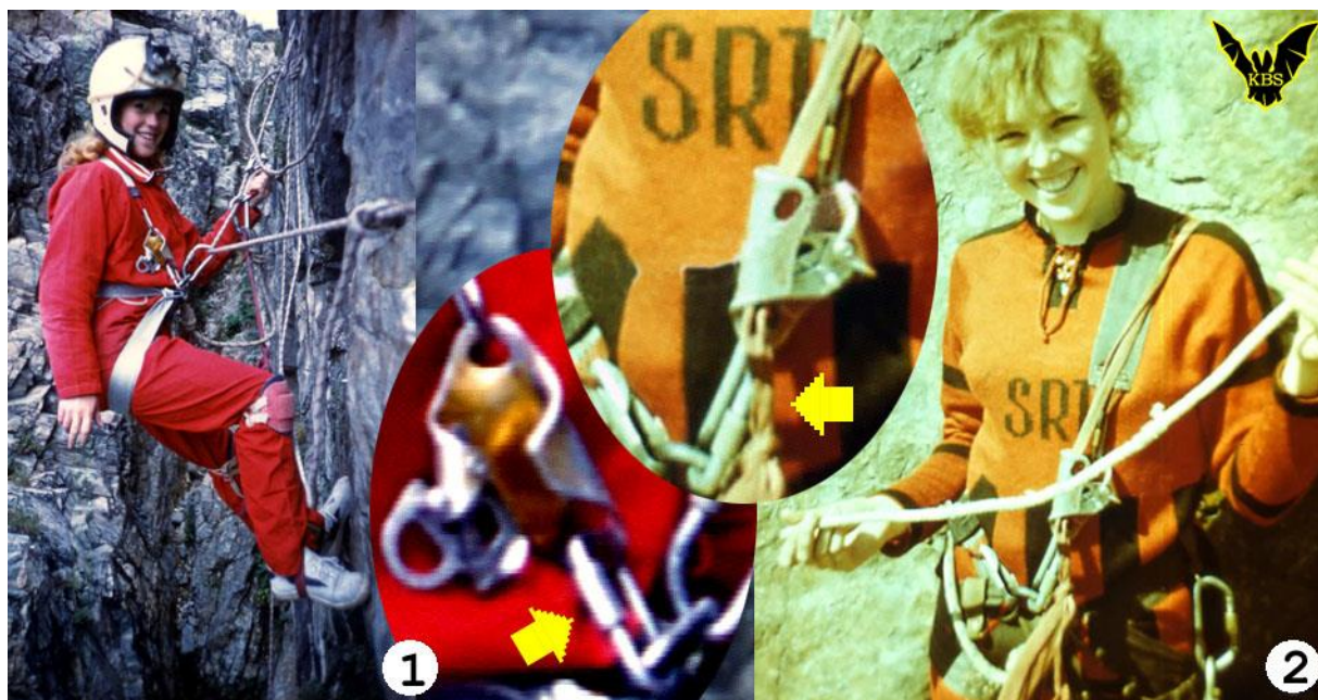
Рис.32. Крепление грудного зажима к дельте с помощью переходного коннектора:
