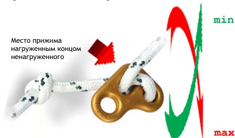
Рис. 20. Отклонение нагруженного конца от плоскости пластины "Slyde" вызывает изменение усилия (min - max) прижима веревки веревкой и соответственно усилия возможного протравливания, которое может и не произойти вовсе.
