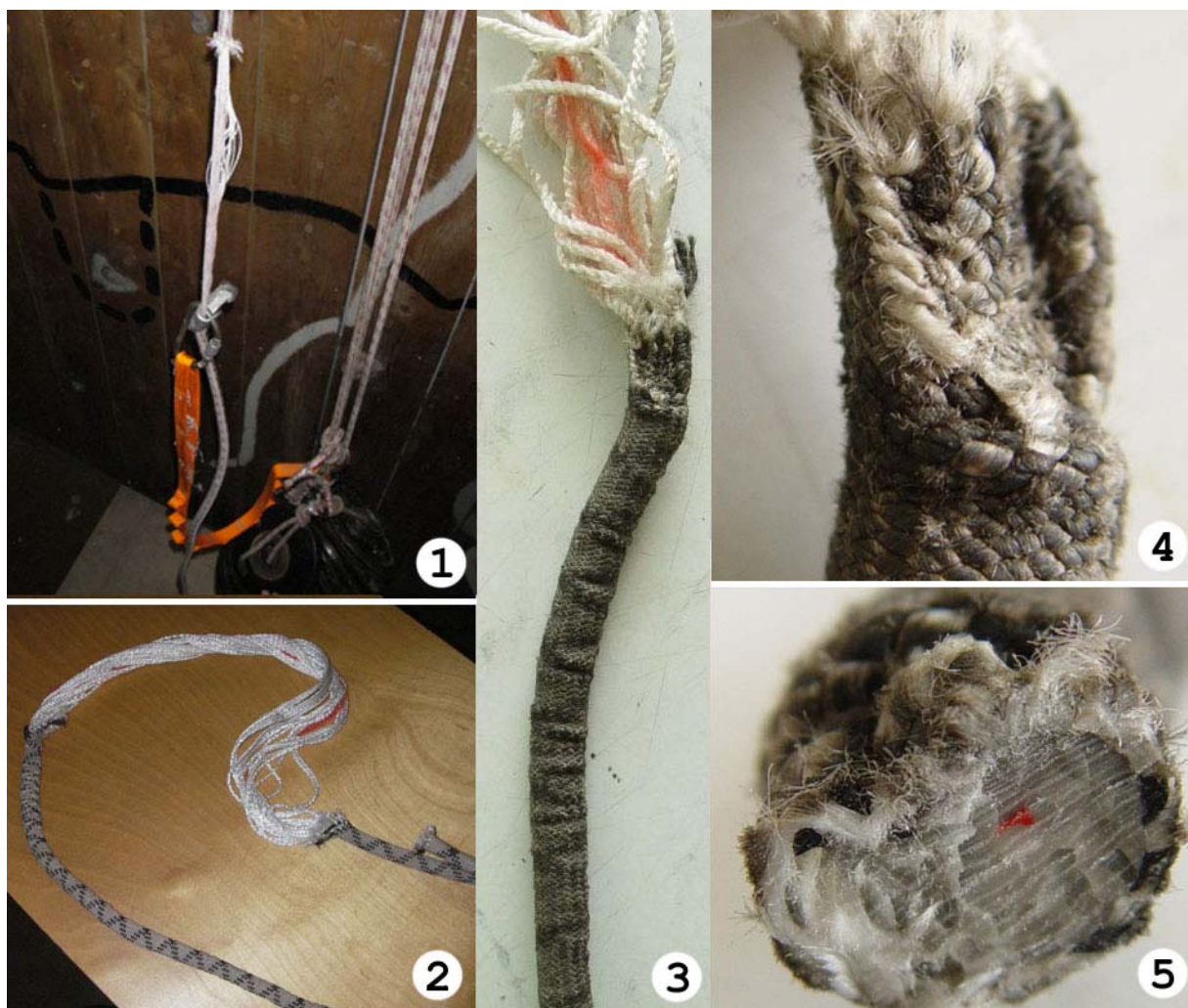
Рис. 17. Характерная картина повреждения веревки эксцентриковым зажимом "асендером" при благополучном исходе падения - веревка не рвется окончательно, останавливая падение (фото присланы Владом Еремеевым, Москва, 2007 год)
